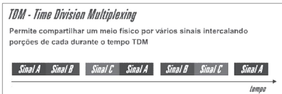
Para realizar esta divisão o Mux divide o tempo infinito em intervalos fixos "T", chamados Frames. Cada Frame é subdividido em subintervalos de tempo ( $t_1, t_2, \dots, t_n$ ). Cada subintervalo destes é chamado Slot. Assim, um Frame contém vários Slots.
